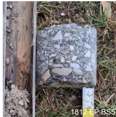
Bild 1 bis Bild 3: Bohrkern 1812 EP BS5 Asphalt und 1812 EP BS6 Asphalt
